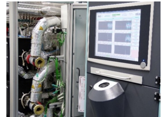
Modellgasprüfstand zur Aktivitätsuntersuchung von Abgaskatalysatoren.
