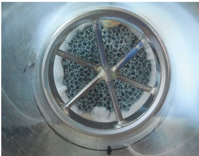
Reaktionsrohr mit Schaumkeramik-Katalysator (Quelle: Fraunhofer ICT).
